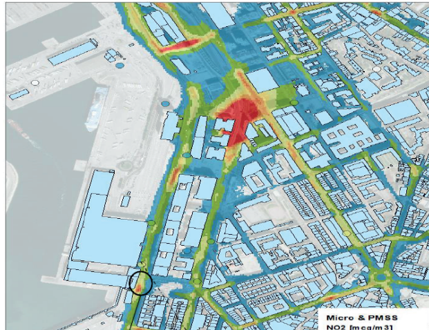
Cartographie de la qualité de l'air calculée à partir des émissions du trafic issues de Gecoair™
